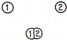
Fig. X-18. — Dans un premier modèle, pour tenir compte des interactions à distance entre atomes, on peut supposer que les boules sont déformables, donc que les chocs ont une durée finie.
